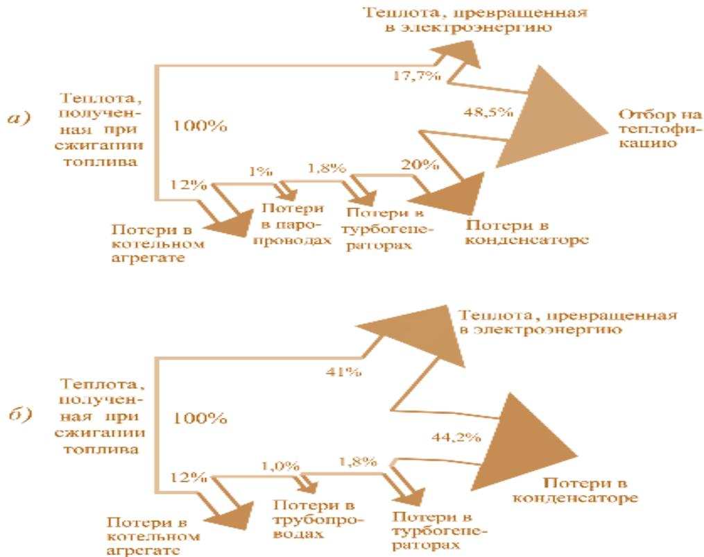
Рис. 1.9. Тепловой баланс: а) – теплоэлектроцентрали ТЭЦ; б) – конденсационной электростанции КЭС
