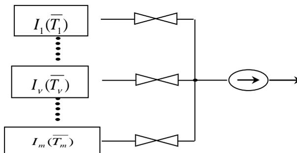
Рис. 3. Система периодических аппаратов с общим сливом.
