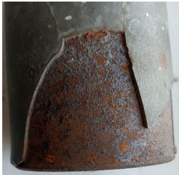
Рис.1. Самопроизвольное отслоение покрытия, нанесенного плазменным напылением
