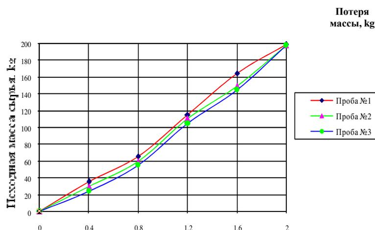
Рис. 1. Зависимость потери массы от исходного при промывке
