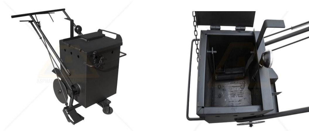
5-rasm. AQSHda yo'l qoplamasidagi yoriqlarni to'ldirish uchun qo'llaniladigan texnologiyaning umumiy ko'rinishi
